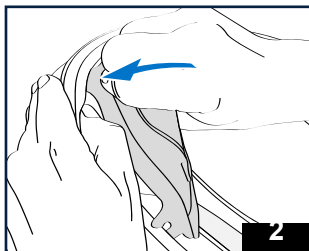
2 - Zasuňte středovou plastovou podložku ochrany proti dechu mezi skořepinu a EPS.
